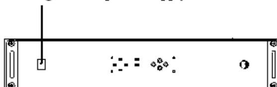
Chiudere l'interruttore di potenza del Monitoring Module in modo che l'Ups può comunicare normalmente con l'unità di controllo. Se dovesse essere necessario sostituire il modulo (hot-swap) questo interruttore deve essere aperto (OFF).
