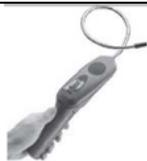
L'immagine a sinistra è lo schema di un rilevatore di perdite di refrigerante.
