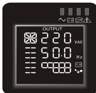
Mostra la tensione e la frequenza in uscita dell'UPS. Come indicato nell'immagine riportata sotto, la tensione in uscita è 220V, la frequenza in uscita è 50Hz.
