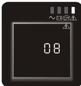
Il cicalino suona e l'UPS blocca l'uscita. Si consiglia di prendere nota del codice errore, di spegnere l'UPS per non aggravare l'UPS di altri danni e contattare l'assistenza tecnica.
