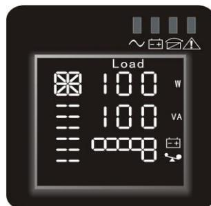
Mostra il valore numerico della potenza attiva (WATT) e la potenza apparente (VA) assorbita dal carico. Ad esempio, come indicato nella figura sotto riportata i WATT del carico sono 100W, i VA sono 100VA.
