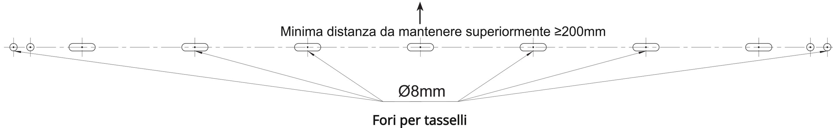
← Minima distanza da mantenere lato sinistro  $\geq 100\text{mm}$
